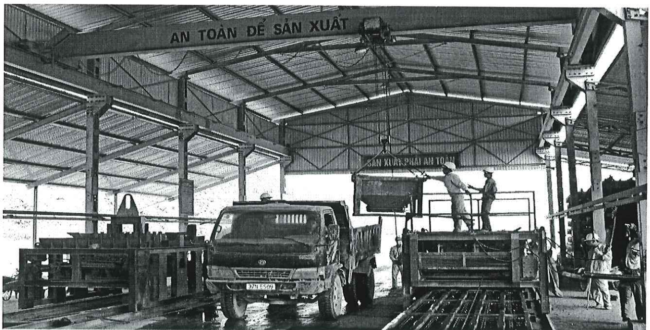
ĐÚC TÀ VỆT BÊ TÔNG DỰ ỨNG LỰC
