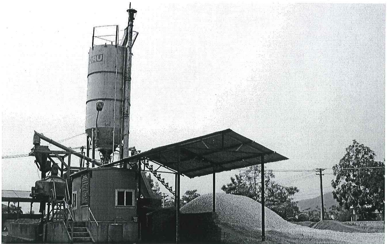
TRẠM TRỘN BÊ TÔNG TƯƠI CHO DÂY CHUYỀN SẢN XUẤT BÊ TÔNG CỐT THÉP DỨ CÔNG SUẤT 36M 3 /h
